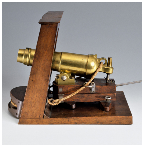
Maquette de caronade. Atelier des arsenaux de Brest, entre 1820 et 1829. Bronze, fer, chanvre et bois © MnM | A. Fux
