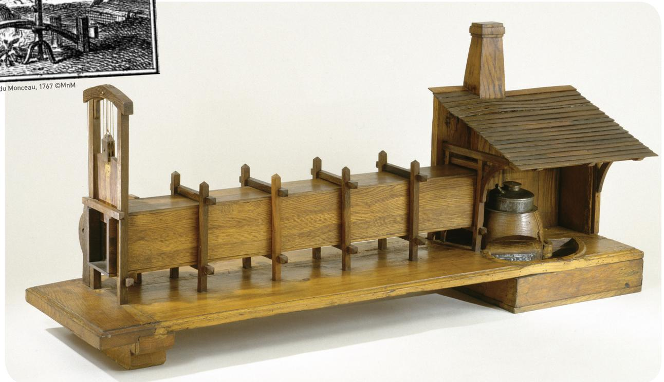
Maquette : Modèle d'étuve pour chauffer et ployer les bordages, 1<sup>er</sup> moitié du XVIII<sup>e</sup> siècle © MnM | P. Dantec
