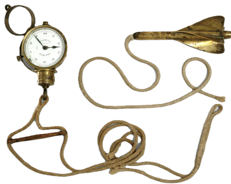
Loch à hélice (sillomètre) L. Garland, fabricant, XIX e siècle © MnM | P. Dantec
