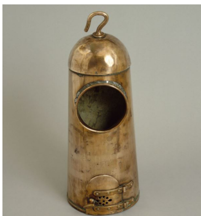
Marmotte ou cache-mèche 4 ème quart 19 e siècle anonyme (fabricant) cuivre ; H.55 cm x D.21 cm Ce cache-mèche est absolument identique au modèle en vigueur en 1852 dessiné dans l'Artillerie de la Marine. 13CN32*©musée national de la Marine
